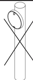
Le luminaire doit être installé sur une surface plane uniquement.
