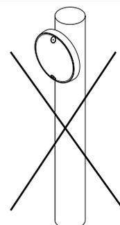
Le luminaire doit être installé sur une surface plane uniquement.
