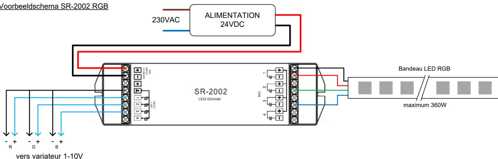
Exemple de schéma SR-2002 RGB+W :
